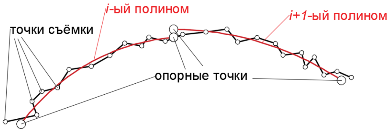
Рисунок 57 – Регуляризация исходных данных (предобработка)
