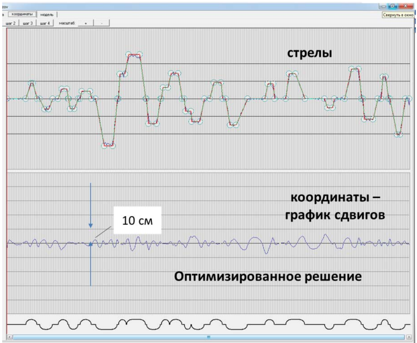
Рисунок 61 – Реконструкция плана трассы железнодорожного пути в концепте Orca
