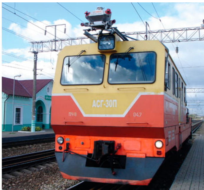
Рисунок 14 – Установка для выполнения мобильного лазерного сканирования
