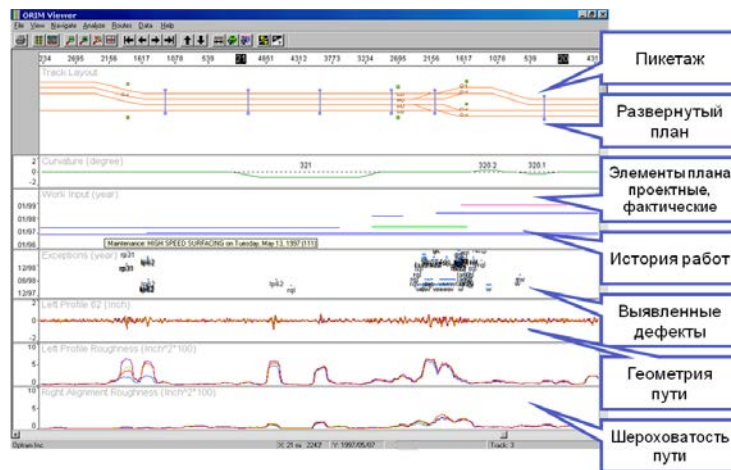
Рисунок 7 - Анализ состояния железнодорожного пути в BentleyOptram
