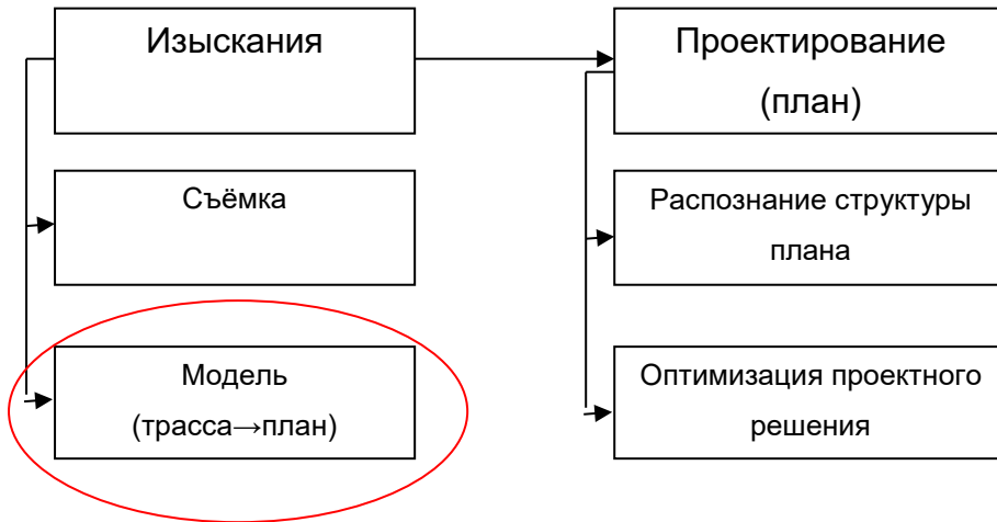
Рисунок 64 – Схема проектно-изыскательского комплекса работ по реконструкции плана
