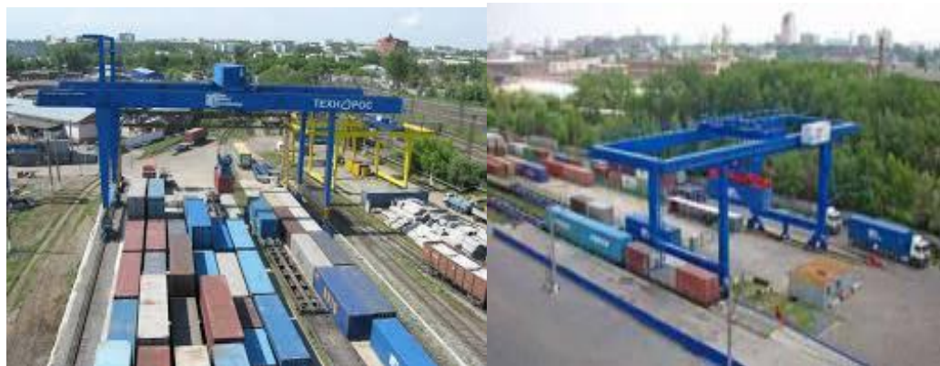
Рисунок 3.7 – Козловые контейнерные краны на рельсовом ходу (RMG - Rail Mounted Gantry Cranes)
