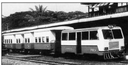
Рисунок 1.3 (а) Рельсовый автобус на базе грузового автомобиля в сфере с пассажирскими вагонами
