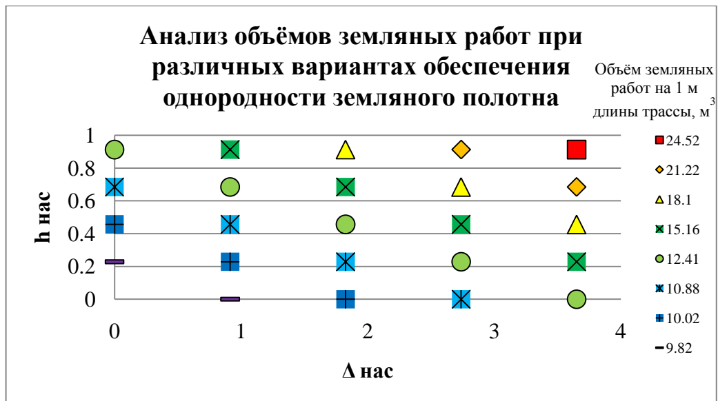
Рисунок 3.13 - Анализ объёмов земляных работ при различных вариантах обеспечения однородности земляного полотна
