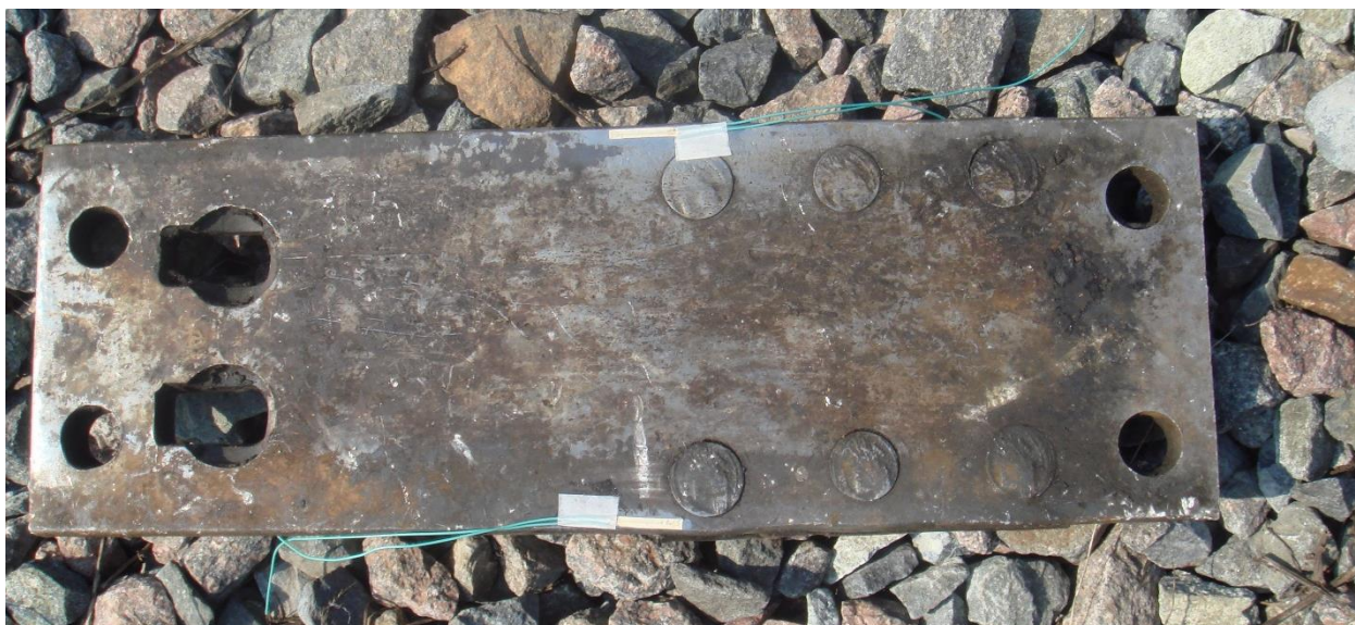
Рисунок 3.4 – Конструкция подкладки с подушкой, изготовленной с использованием технологии на заклепках, подготовленная к динамико-прочностным испытаниям
