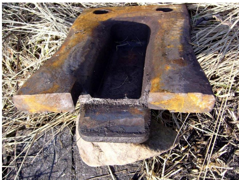
Рисунок 2.3 - Излом подкладок с подушкой, изготовленных методом горячей штамповки
