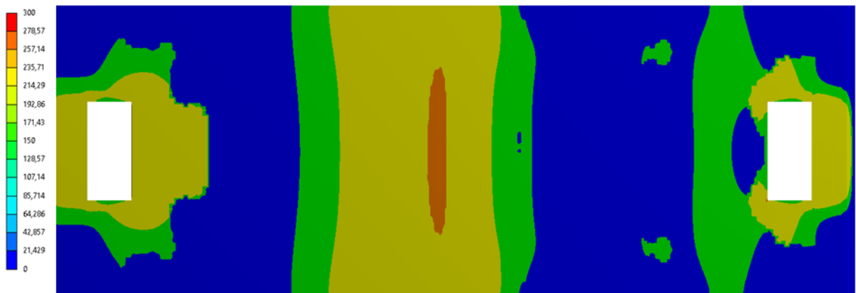
Рисунок 5.29 - Распределение амплитуд напряжений эквивалентного симметричного цикла для цельнолитой подкладки с зауженной подушкой (подошва подкладки)
