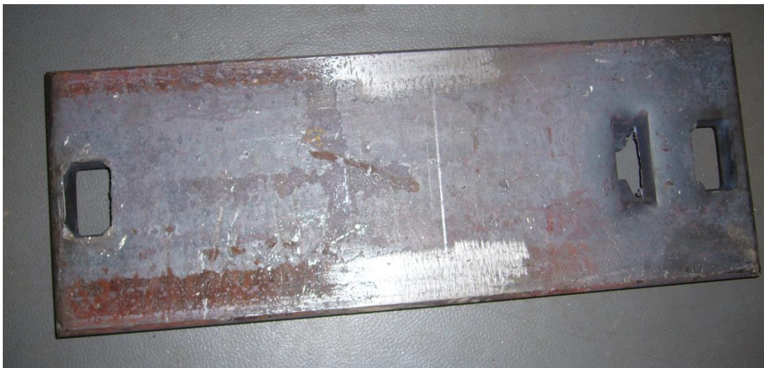
Рисунок 1.9 - Подкладка с подушкой, изготовленная с использованием технологии продольной сварки (вид снизу)
