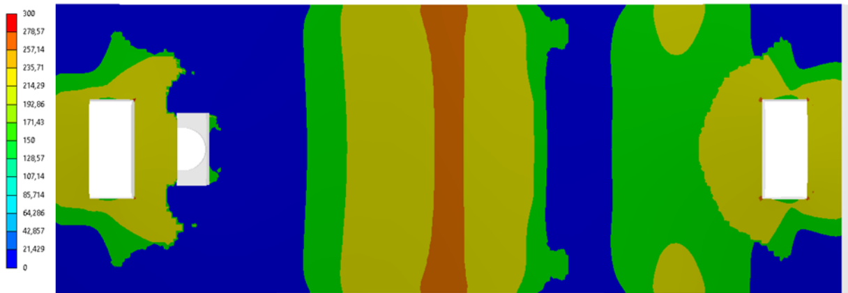
Рисунок 5.24 - Распределение обобщённых коэффициентов запаса для подкладки без отверстий с подушкой шириной на 50 мм меньше ширины подкладки (подошва подкладки)
