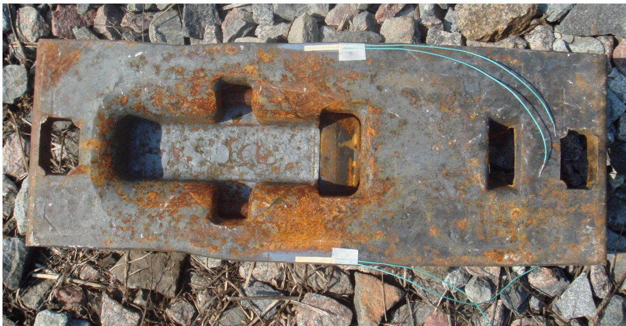
Рисунок 3.3 – Конструкция подкладки с подушкой, изготовленной с использованием технологии горячей штамповки, подготовленная к динамико-прочностным испытаниям
