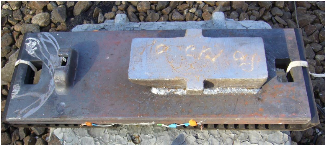
Рисунок 1.8 - Подкладка с подушкой, изготовленная с использованием технологии продольной сварки (вид сверху)
