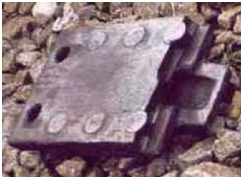
Рисунок 2.1 - Излом подкладки с подушкой на заклёпках
