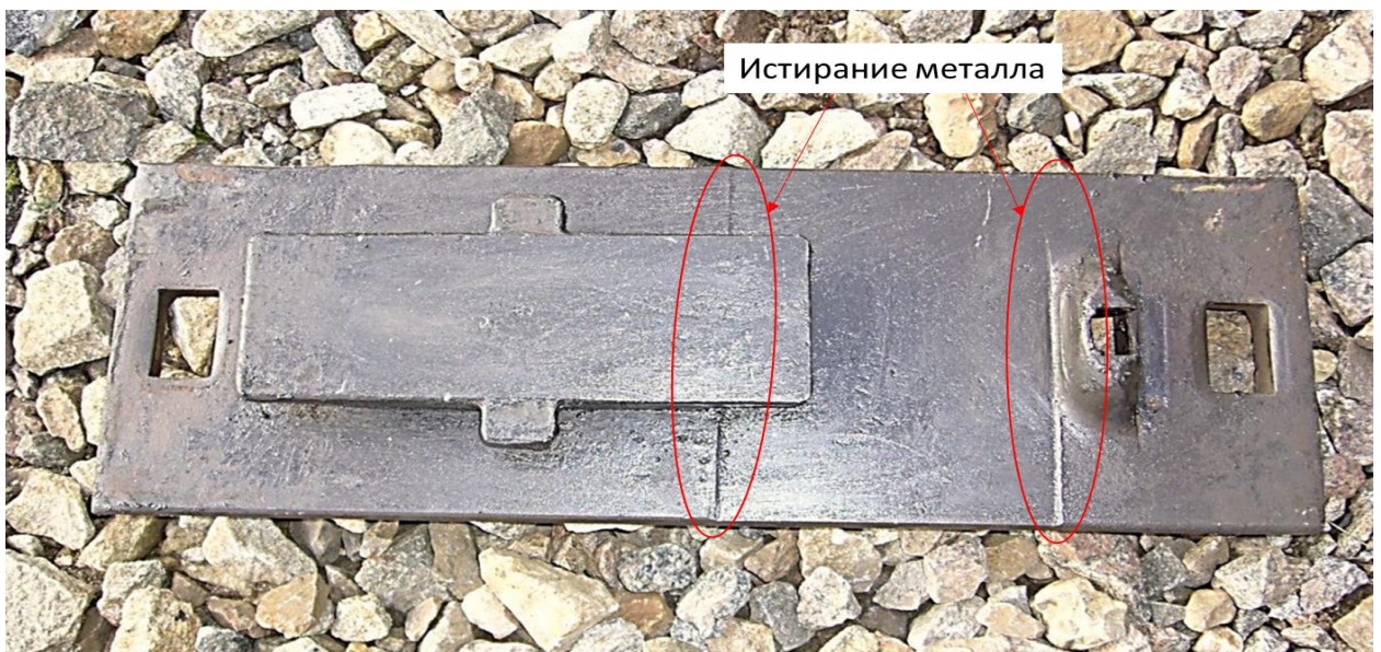
Рисунок 2.6 - Новый вид дефекта подкладки с приварной подушкой - истирание металла под рельсом
