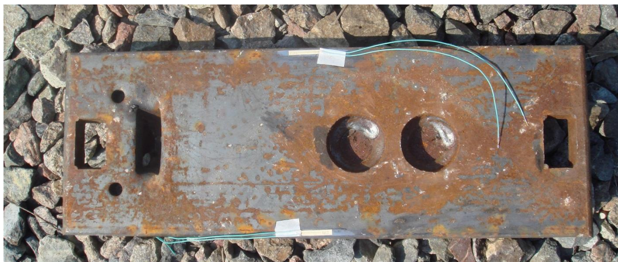
Рисунок 3.5 - Конструкция подкладки с подушкой, изготовленной с использованием технологии сварки, подготовленная к динамико-прочностным испытаниям
