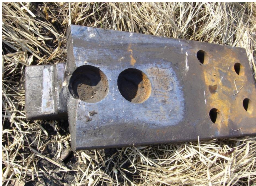
Рисунок 2.2 - Излом подкладок с подушкой, изготовленных с использованием сварки через отверстия в подкладке
