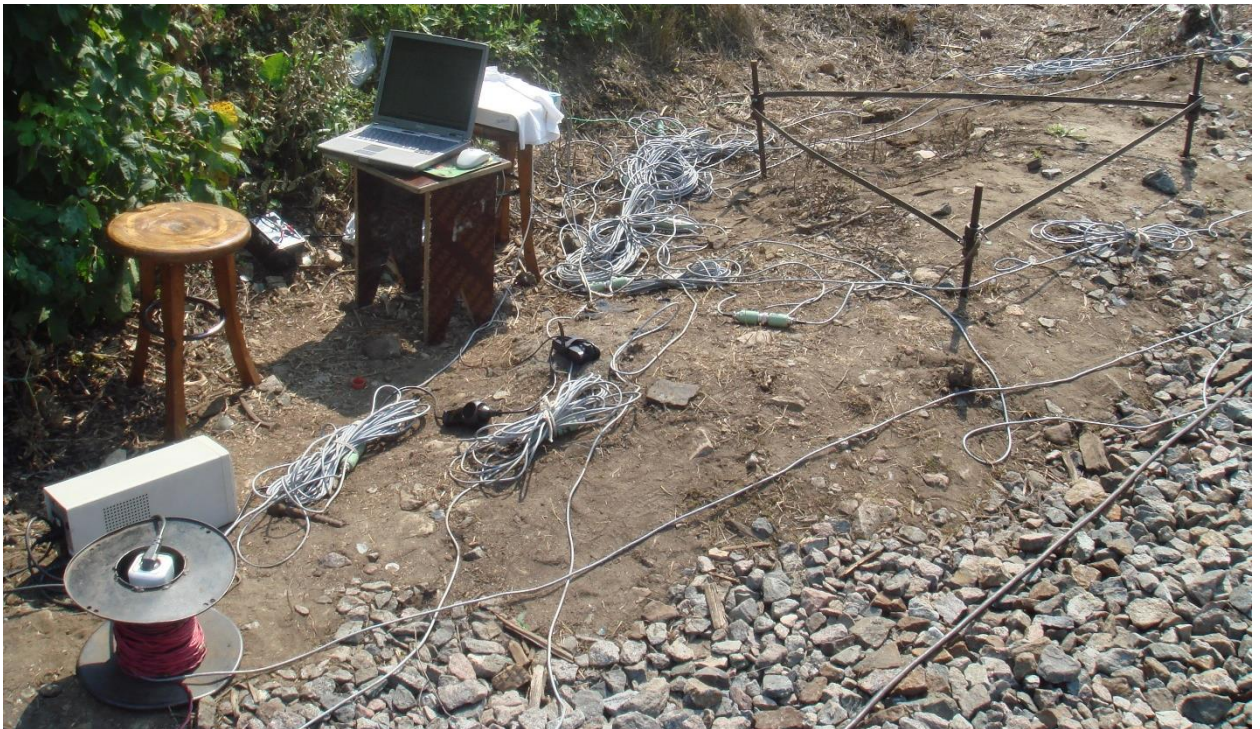
Рисунок 3.1 - Тензометрическая установка во время проведения динамико-прочностных испытаний подкладок с подушкой трех различных конструкций
