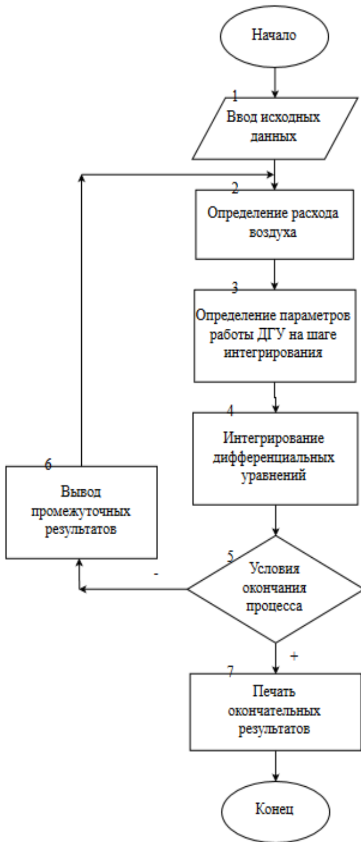
Рисунок 2 - Блок-схема алгоритма расчета рабочих процессов совместной работы дизеля с лопаточными машинами
