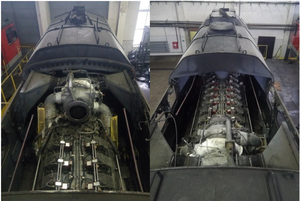
Рисунок 20 - Электроуправляемые топливные насосы высокого давления и турбокомпрессор ТК35В-36 системы ЭСУТПН
