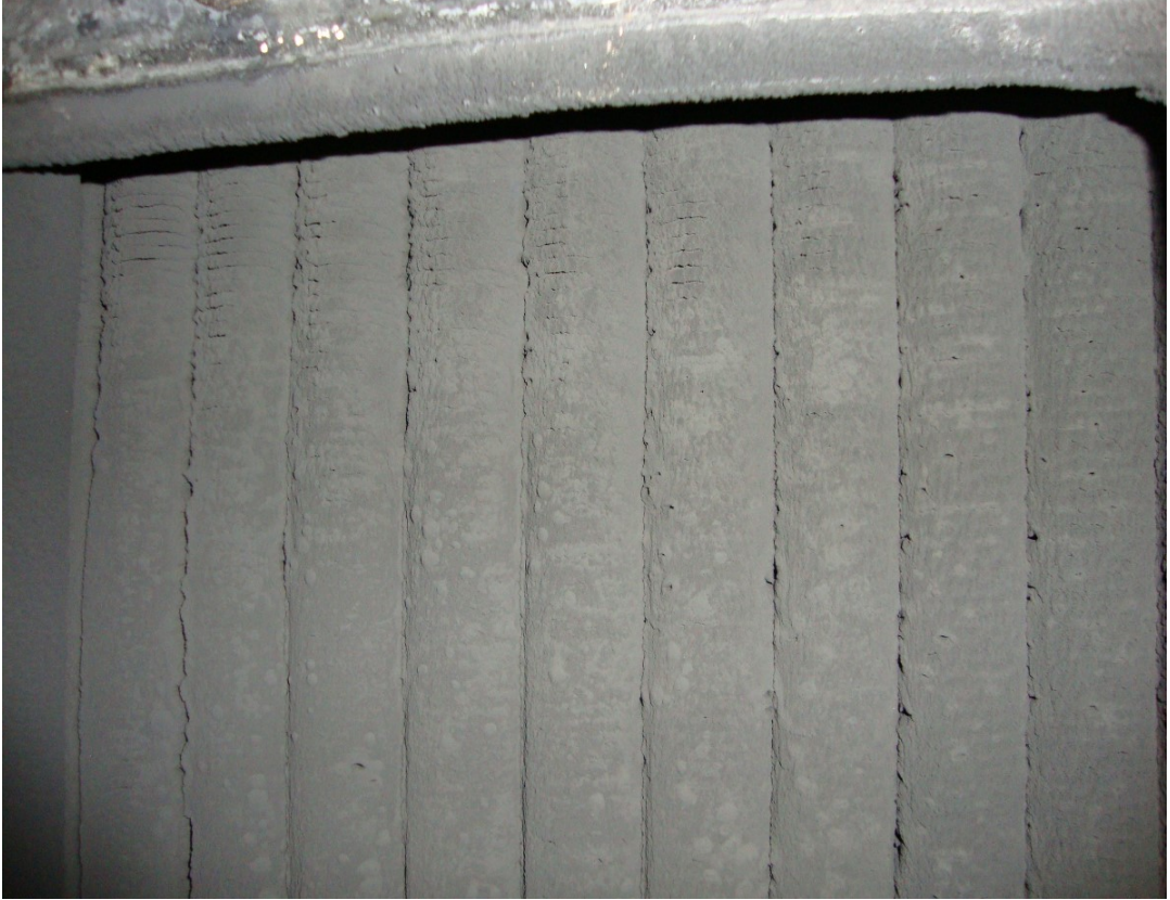
Рисунок Д1 - Общий вид трубок охладителя наддувочного воздуха до промывки
