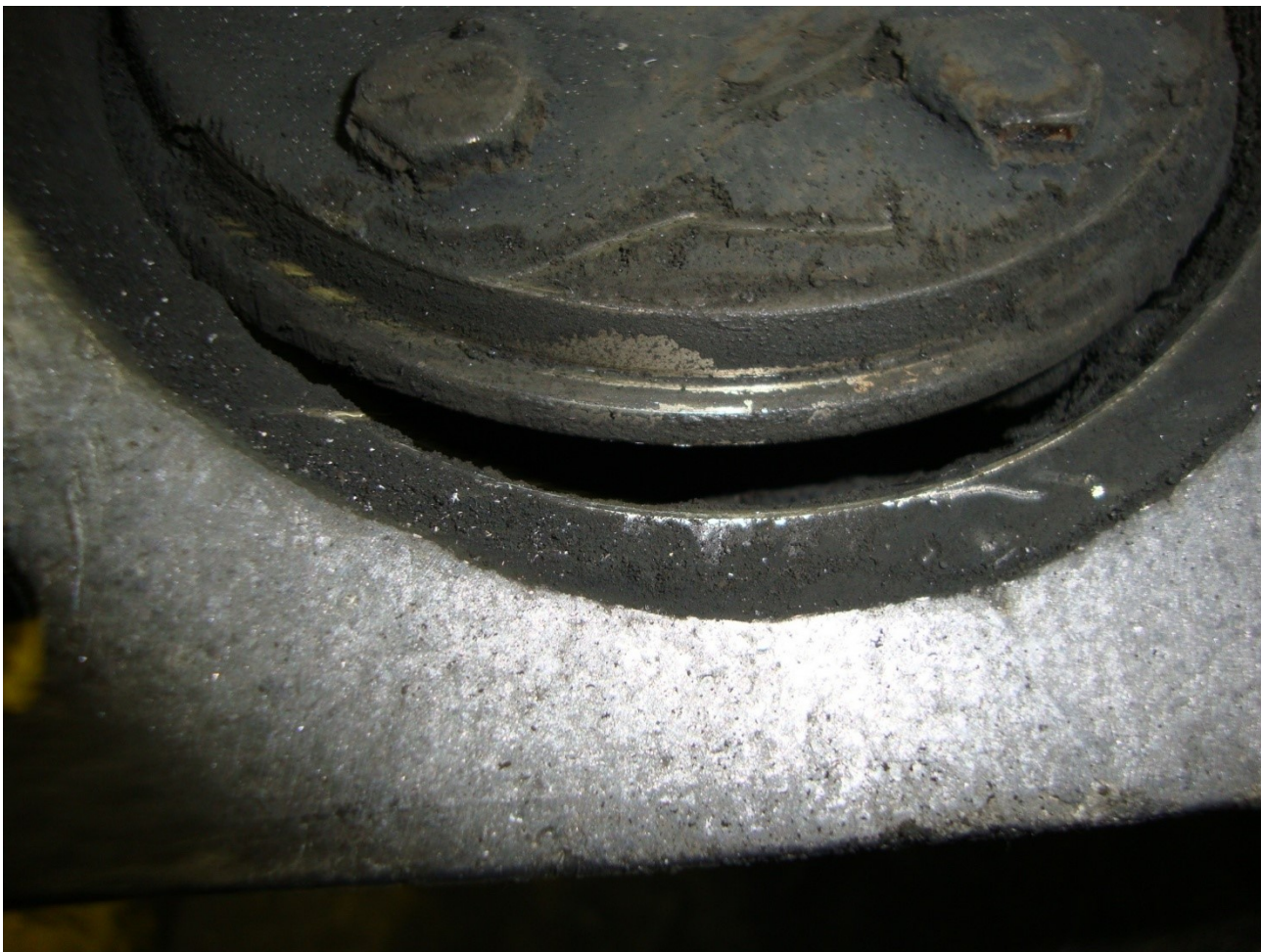
Рисунок 15 - Заклинивший клапан перепуска
