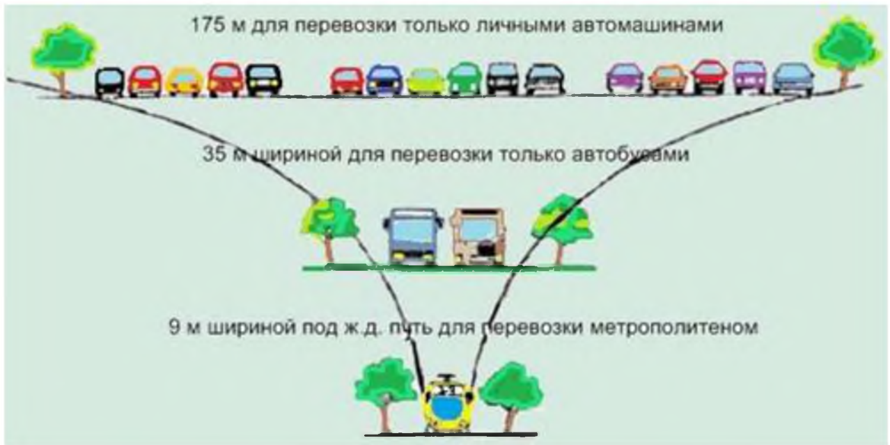
Рисунок 1.1 – Сопоставление видов транспорта по ширине проезжей части занимаемой ими городской территории (при перевозке 50 тыс. пасс/час в одном направлении)
