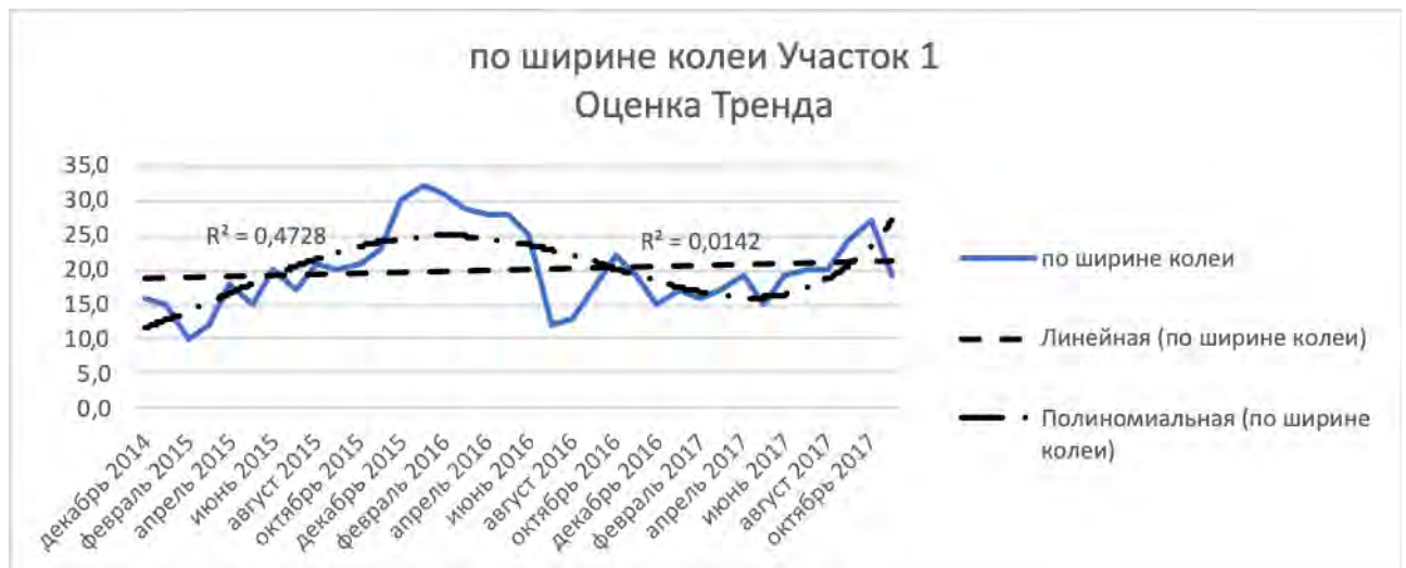
Рисунок 3.7. Тренды закономерностей изменения состояния участка 1 пути по параметру рихтовка на основе полиномиальных и линейных моделей
