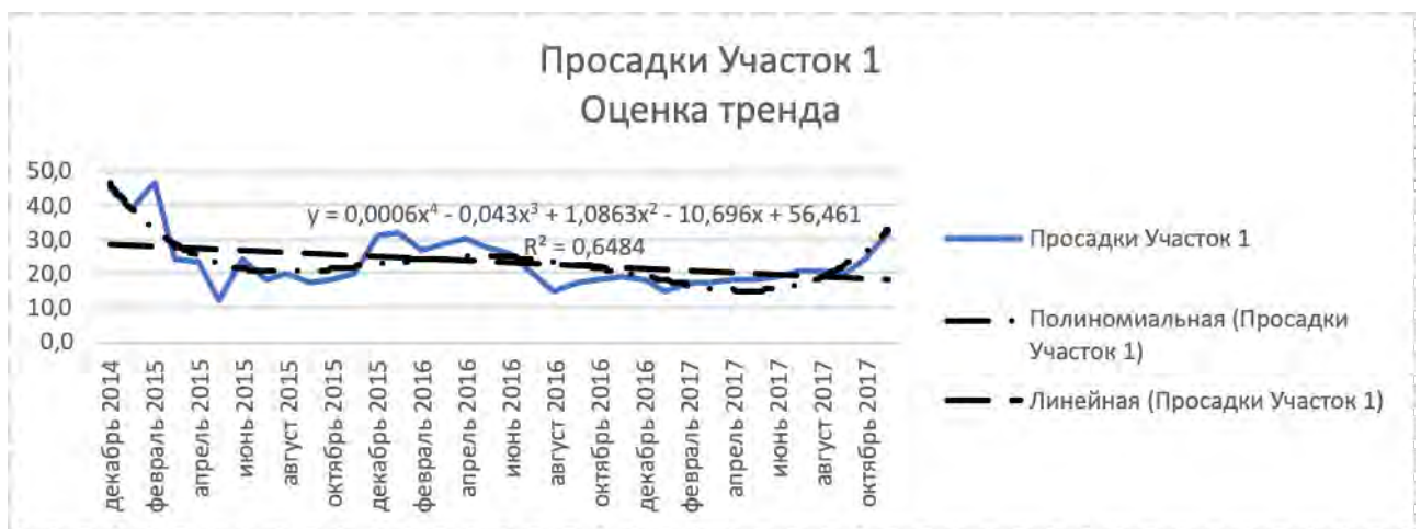
Рисунок 3.3. Тренды закономерностей изменения состояния участка 1 пути по параметру просадки на основе полиномиальных и линейных моделей
