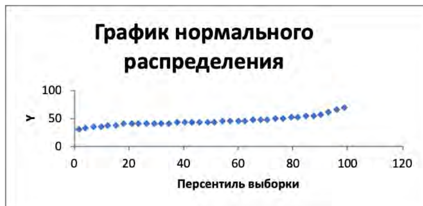
Рисунок 3.14 График проверки гипотезы о виде распределения по выборке второго участка пути
