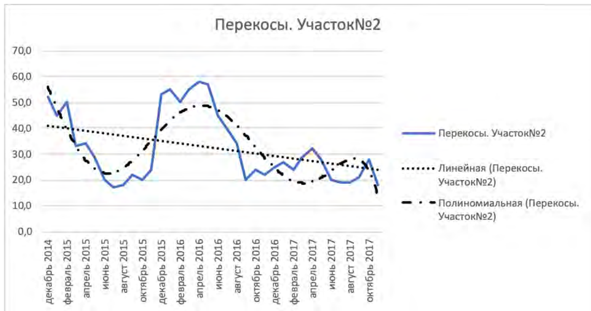
Рисунок 3.21 Закономерности на основе разных моделей для перекосов по участку 2
