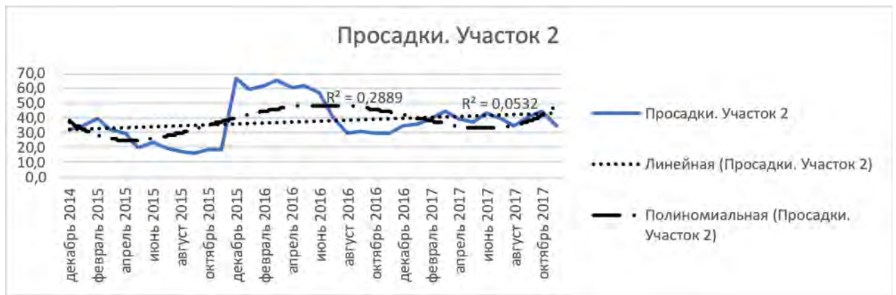
Рисунок 3.4. Тренды закономерностей изменения состояния участка 2 пути по параметру просадки на основе полиномиальных и линейных моделей
