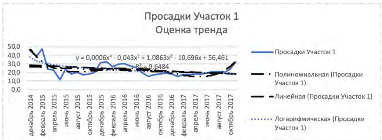
Рисунок 3.22 Закономерности на основе разных моделей для просадок по участку 1
