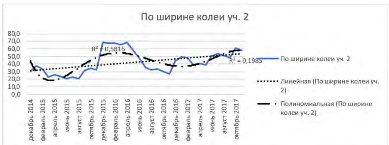
Рисунок 3.8. Тренды закономерностей изменения состояния участка 2 пути по параметру рихтовка на основе полиномиальных и линейных моделей
