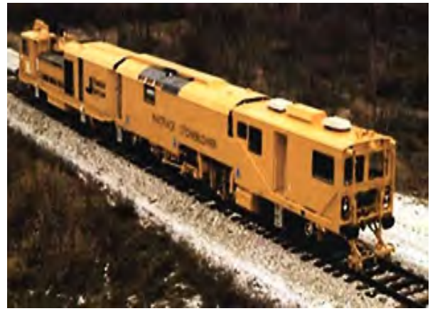
Рисунок 1.10. Общие виды некоторых зарубежных балластно-распределительных машин
