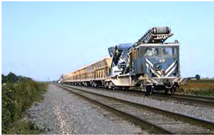
Рисунок 1.10. Общие виды некоторых зарубежных балластно-распределительных машин
