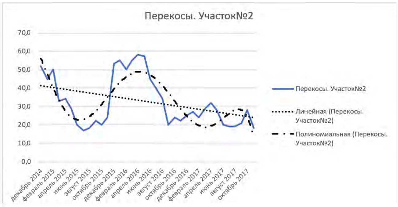
Рисунок 3.2. Тренды закономерностей изменения состояния участка 2 пути по параметру перекосы на основе полиномиальных и линейных моделей
