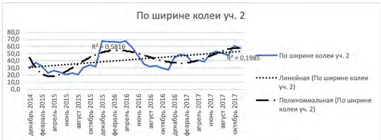
Рисунок 3.27 Закономерности на основе разных моделей для ширины колеи по участку 2.
