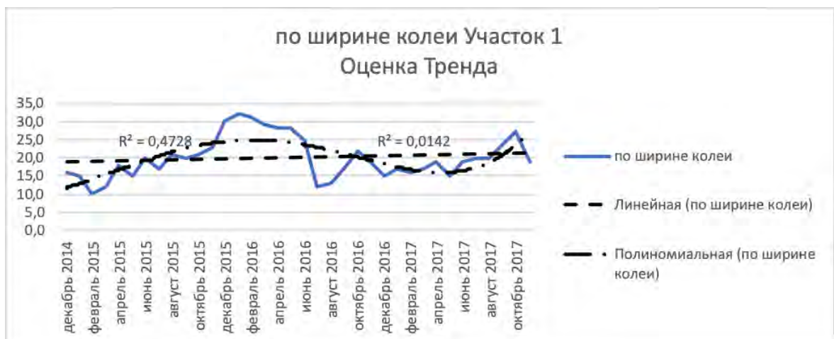
Рисунок 3.26 Закономерности на основе разных моделей для ширины колеи по участку 1
