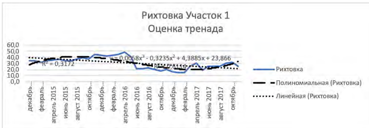
Рисунок 3.24 Закономерности на основе разных моделей для рихтовок по участку 1
