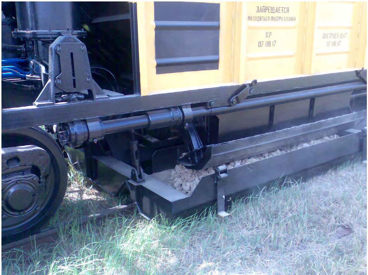
Рисунок 1.3. Крышка хоппер-дозатора, обеспечивающая прерывание выгрузки
