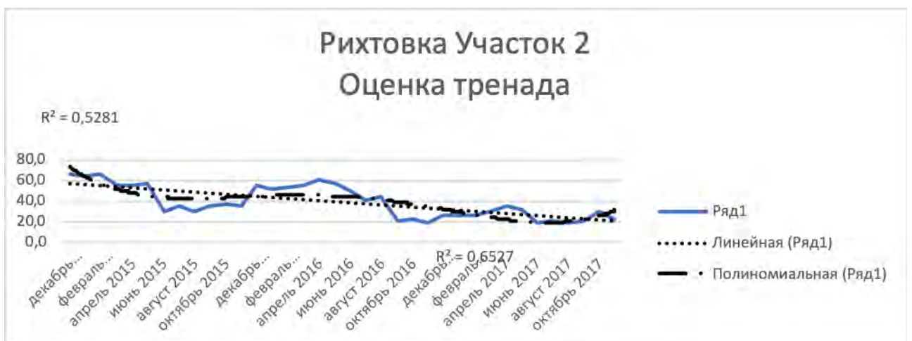
Рисунок 3.6. Тренды закономерностей изменения состояния участка 2 пути по параметру рихтовка на основе полиномиальных и линейных моделей
