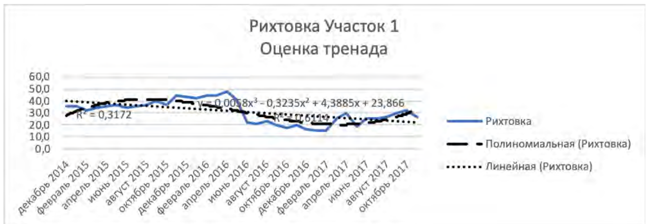
Рисунок 3.5. Тренды закономерностей изменения состояния участка 1 пути по параметру рихтовка на основе полиномиальных и линейных моделей
