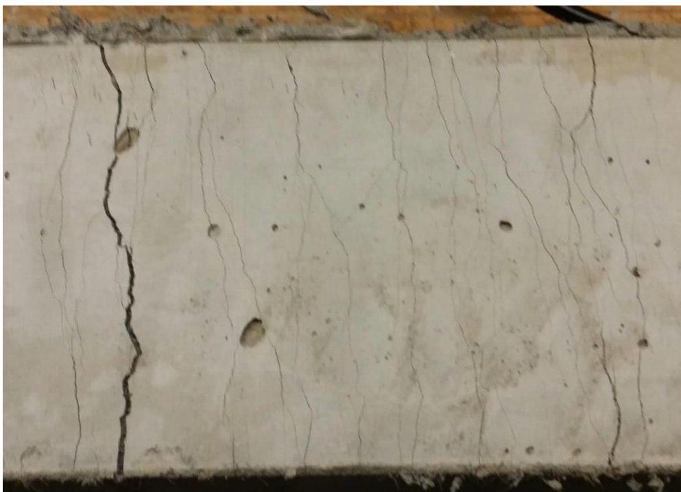
Рисунок А.20 – Типичный разрушенный образец из ЕСС с добавлением бактерий с макротрещиной и множественными микротрещинами
