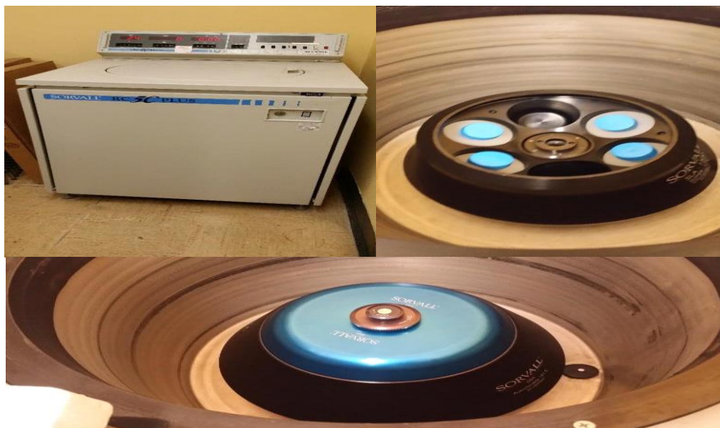
Рисунок А.5 – Центрифуга (слева); установленные в роторе центрифуги пробирки фирмы «Falcon» (справа), ротор с крышкой, готовый к центробежной обработке образцов (снизу)
