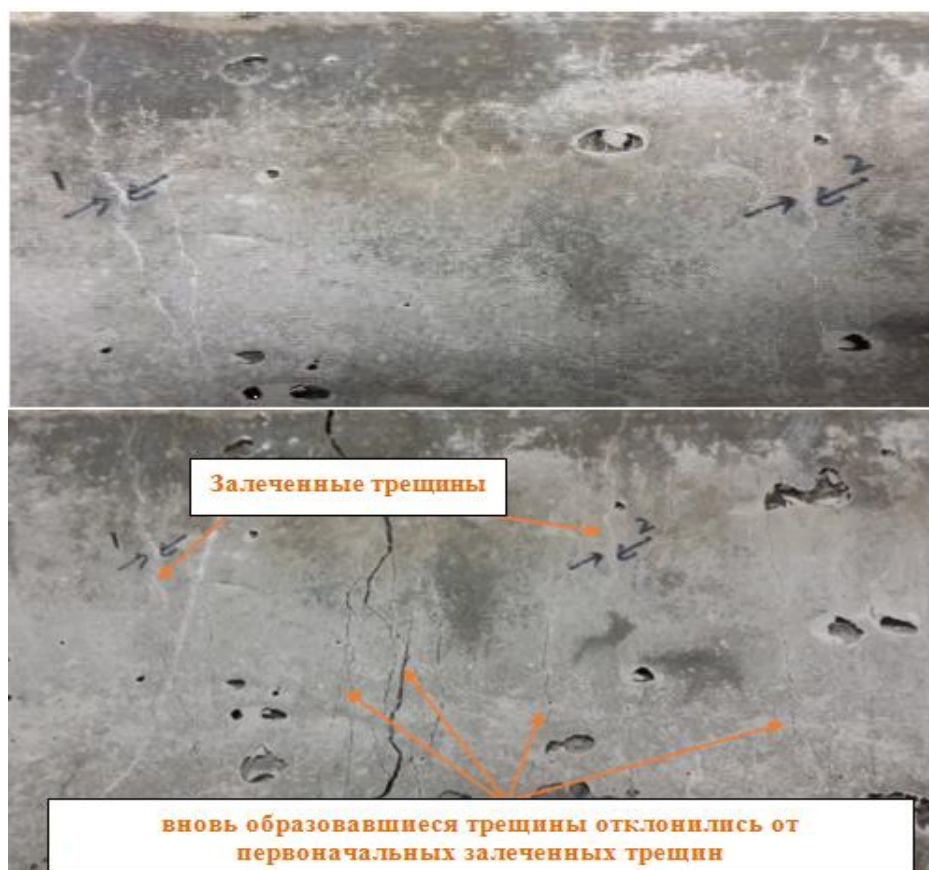
Рисунок 4.54 – Отклонение от направления образования трещины в восстановленном образце с иммобилизованными в цеолите бактериями B. subtilis до (вверху) и после (снизу) повторного нагружения
