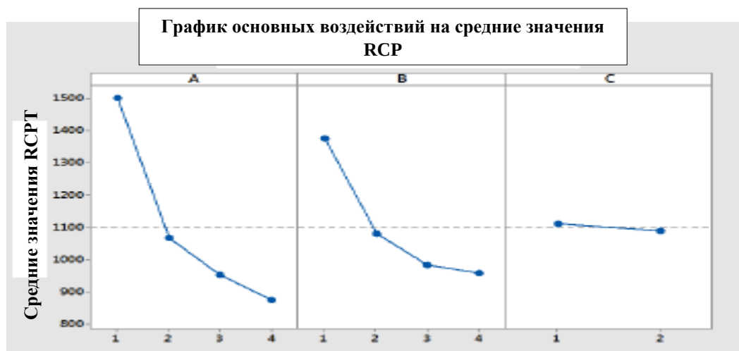
Рисунок 5.10 – График основных воздействий на среднее значение RCP в армированном волокном цементном растворе
