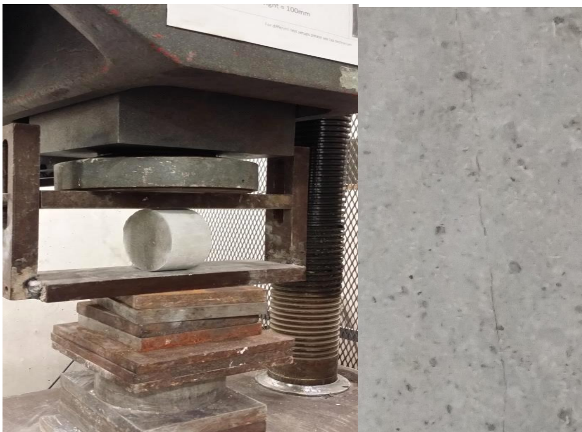
Рисунок А.14 – Испытание на растяжение до появления трещин (слева) и образовавшаяся трещина (справа)
