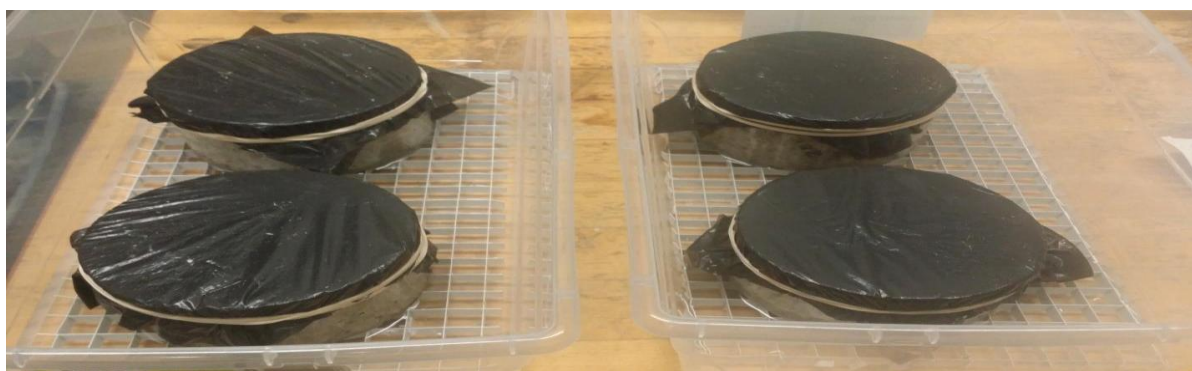
Рисунок А.15 – Схема проведения испытания для определения сорбционной способности
