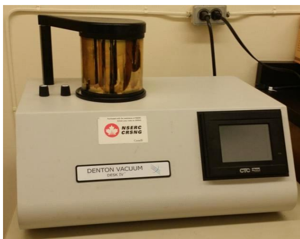
Рисунок А.17 – Система для нанесения покрытий «Denton vacuum Desk IV» (слева); образец, готовый к нанесению покрытия (справа)
