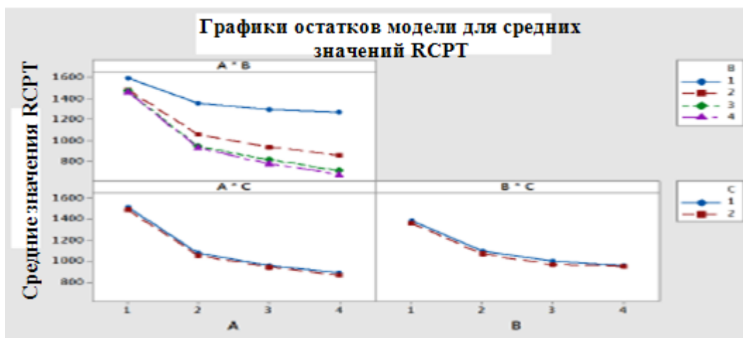
Рисунок 5.7 – Графики двухфакторного взаимодействия для среднего значения параметра RCP фиброармированного цементного раствора
