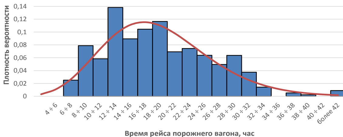
Рисунок 2.3 – Эмпирическая плотность относительной частоты f^*(x) и теоретическая плотность вероятности f(x) времени следования вагона при дальности порожнего рейса полувагона 236 км
