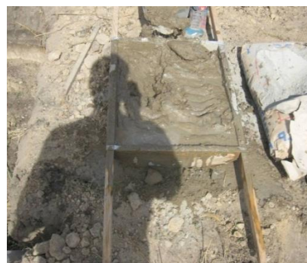
Рисунок 3.6 – Фото натурной модели насыпи
