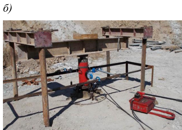
Рисунок 3.12 – Установка штампового испытания:
