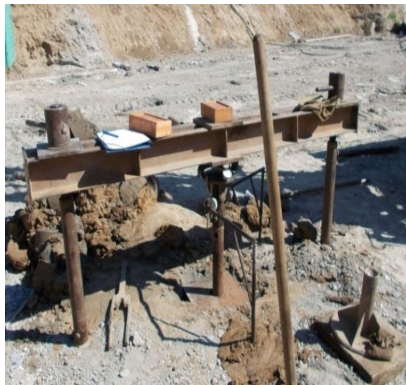
Рисунок 3.13 – Установка испытания винтовым штампом с использованием анкерной системы:
