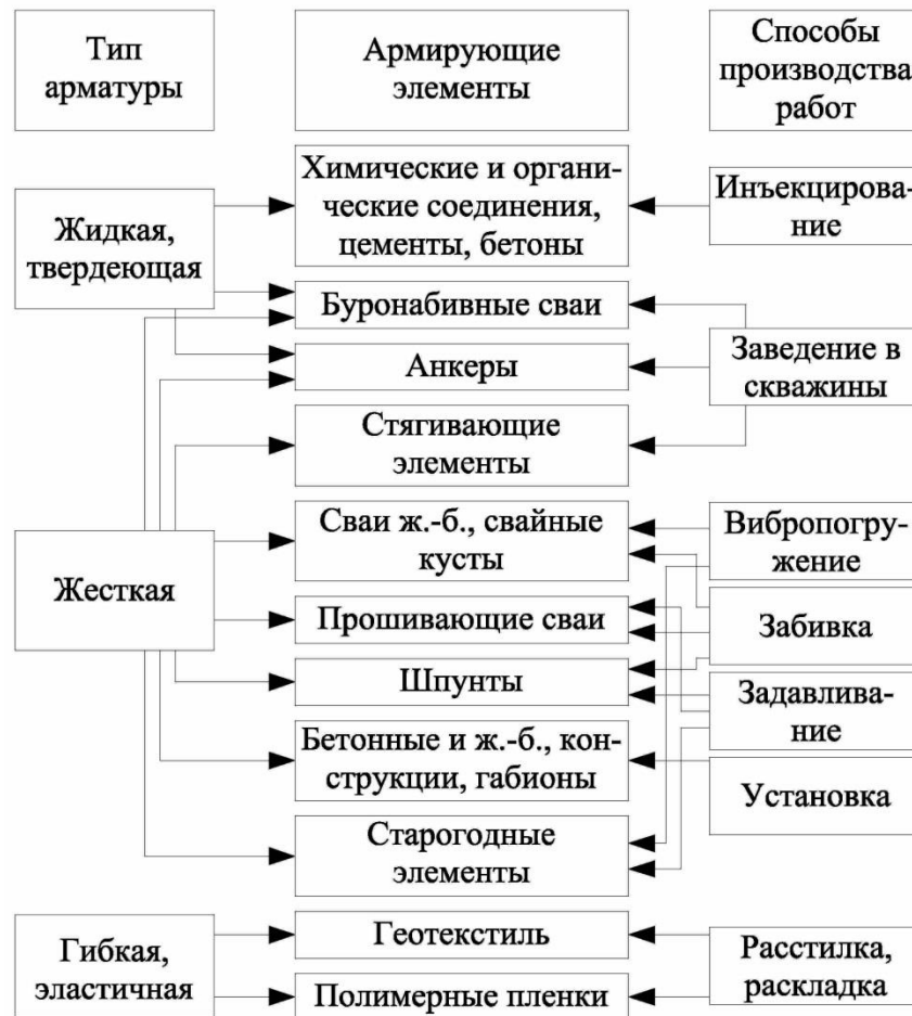
Рисунок 1.5 – Структурная схема применения армогрунтов [235]
