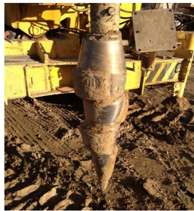
Рисунок 1.6 – Модели раскатчика скважин:
