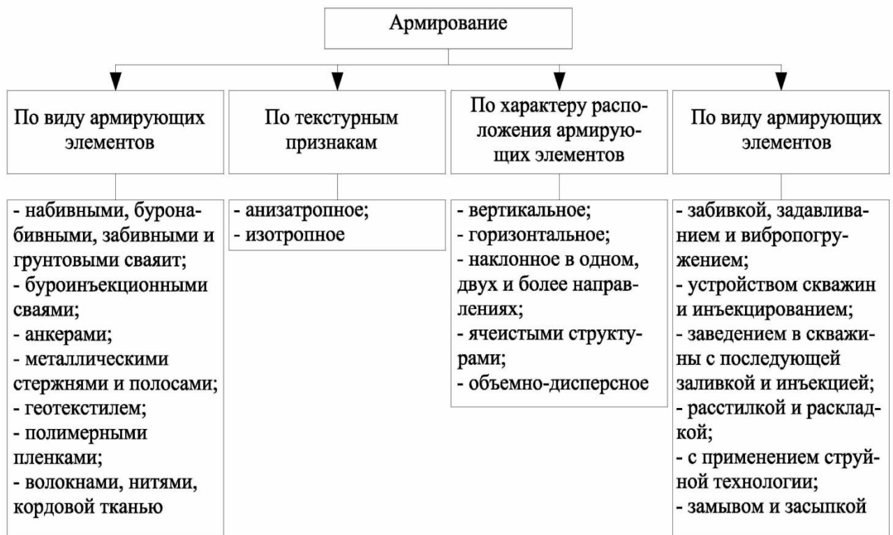
Рисунок 1.4 – Классификация признаков армирования [137]
