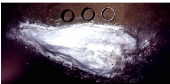
Рисунок 5.29 – Результаты вскрытия контрольного шурфа (формы затвердевшего раствора):
