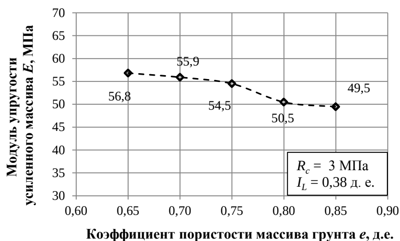
Рисунок 3.20 – Влияние коэффициента пористости грунта на модуль упругости массива, армированного набивными сваями в раскатанных скважинах
