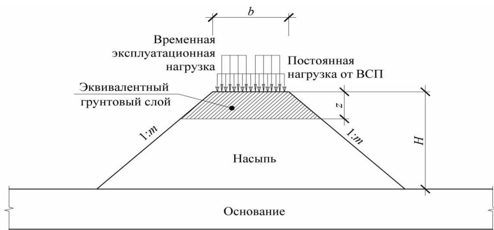
Рисунок 2.14 – Упрощенная модель эксплуатируемой высокой насыпи М1.1, содержащая эквивалентный слой
