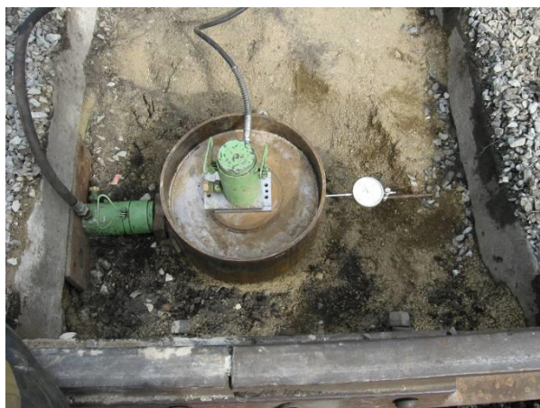
Рисунок 3.8 – Вид установки для выполнения среза целиков
