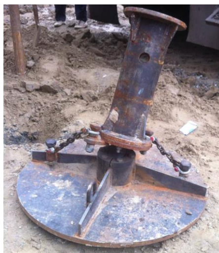
Рисунок 3.10 – Плоский штамп круглого сечения площадью 5 000 см 2
