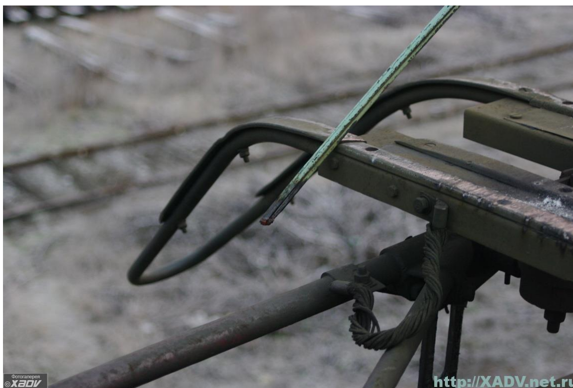
Рисунок 13. Пережог контактного провода электрической дугой
