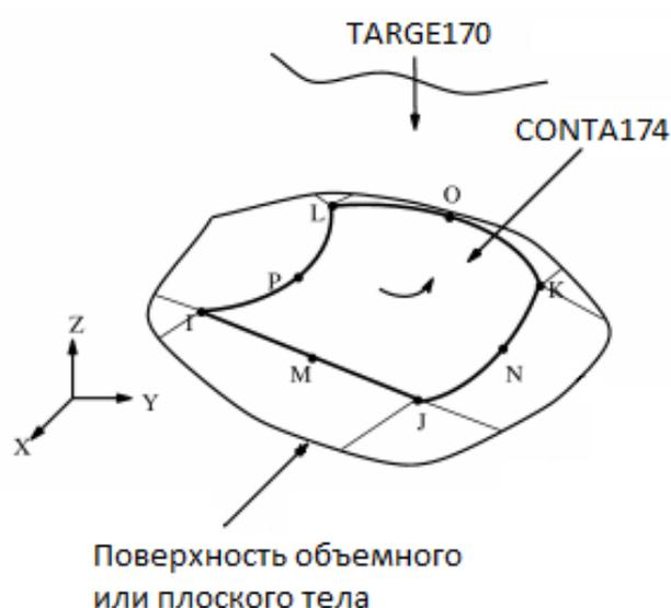
Рисунок П2.2. Контактная пара «поверхность – поверхность»
