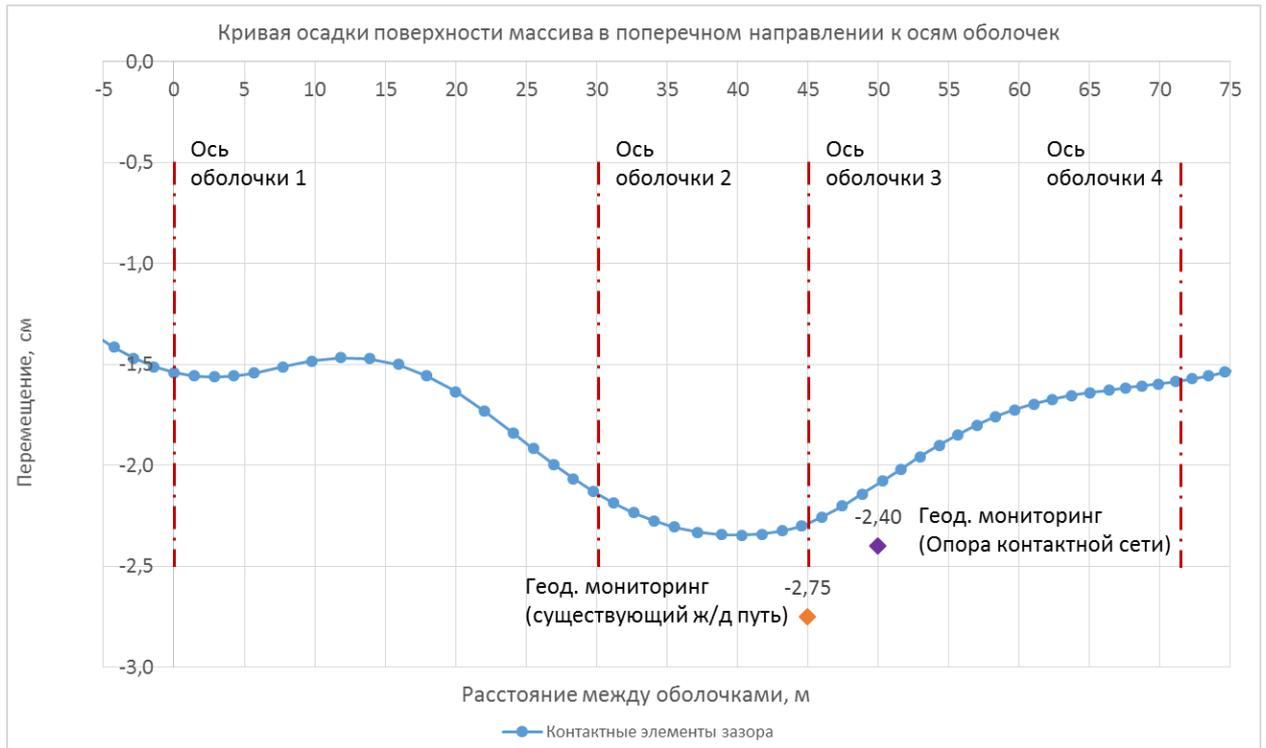
Рисунок 3.30. Кривая осадки поверхности по результатам численных расчетов и максимальные перемещения существующего ж/д пути и опоры контактной сети, полученные из геодезического мониторинга
