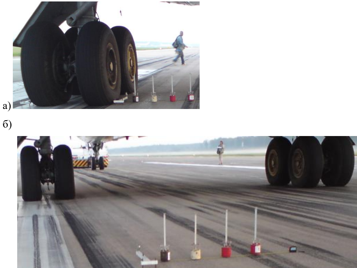
Рисунок 3.5 – Измерение прогибов покрытия опорой ВС:
