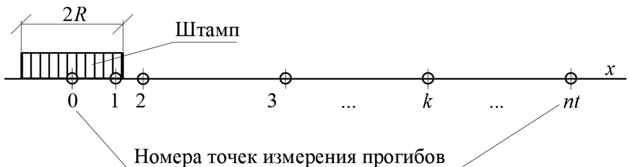
Рисунок 3.3 – Схема измерения прогибов штампом
