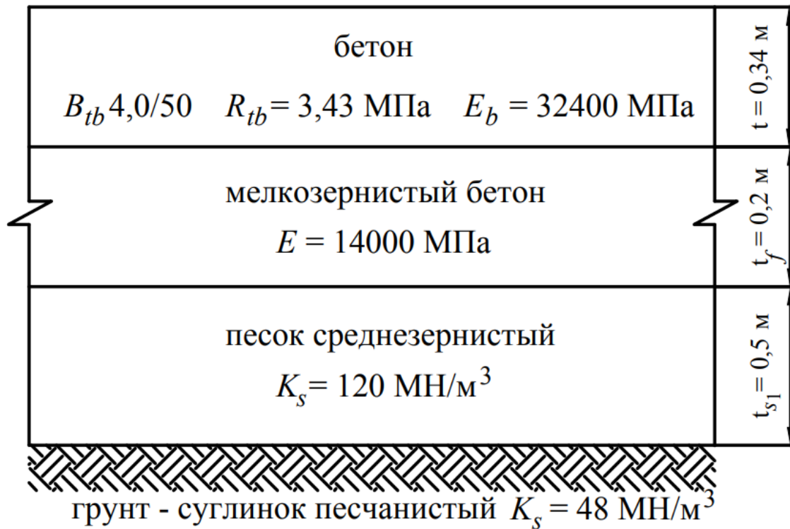
Рисунок 4.5 – Конструкция испытываемого покрытия
