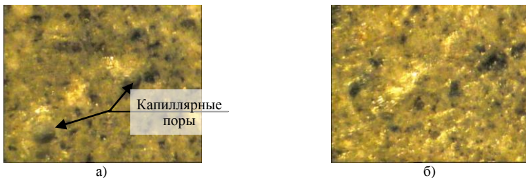
Рисунок 7 – Микроструктура цементного камня: а) - контрольного образца без добавок (режим 0-6-2) ч; б) - образца с ПКЭ (режим 0-6-2) ч при 800-кратном увеличении
