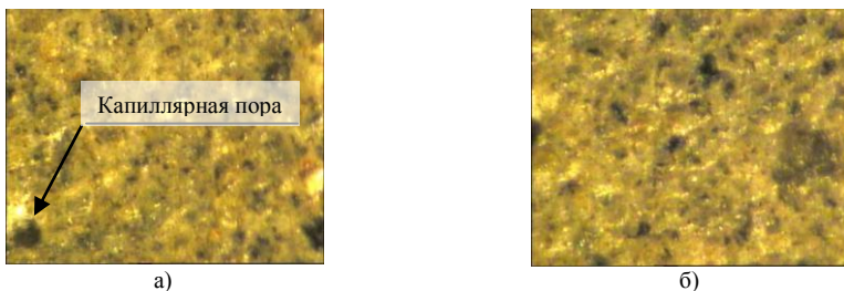
Рисунок 8 – Микроструктура цементного камня: а) - контрольного образца без добавок (режим 2-6-2) ч; б) - образца с ПКЭ (режим 2-6-2) ч при 800-кратном увеличении
