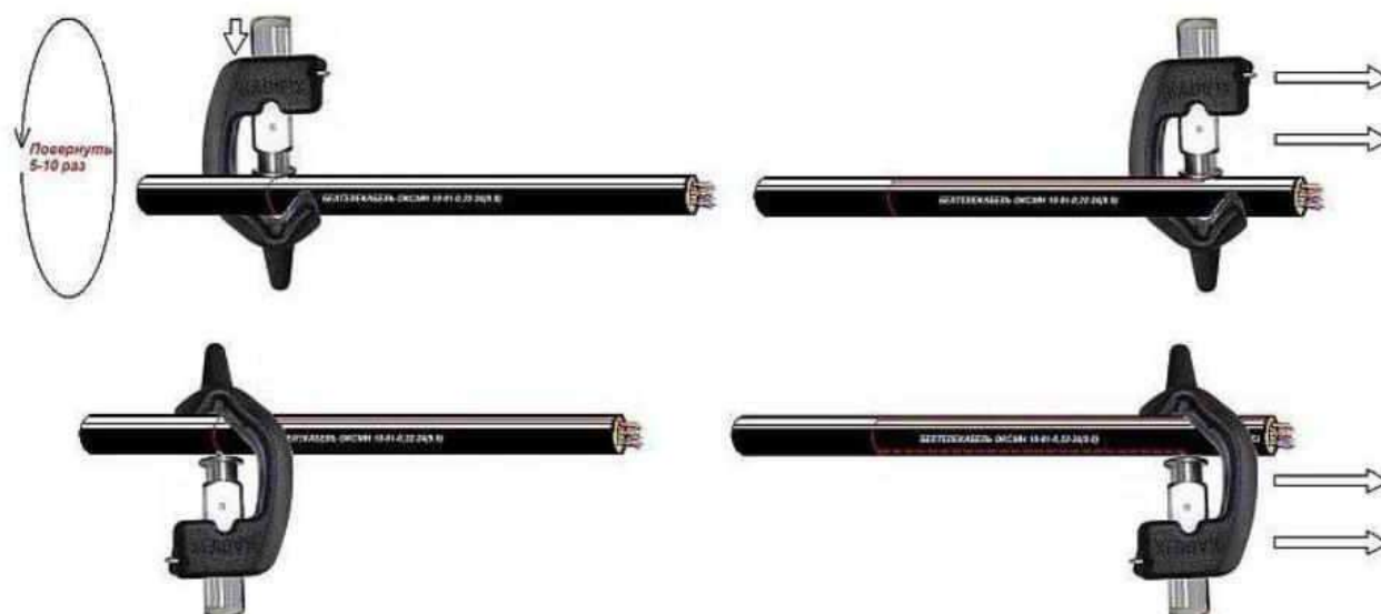
Рисунок 6 – Снятие внешней оболочки кабеля ножом-стриппером
