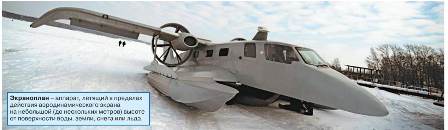
Экраноплан – аппарат, летящий в пределах действия аэродинамического экрана на небольшой (до нескольких метров) высоте от поверхности воды, земли, снега или льда.
