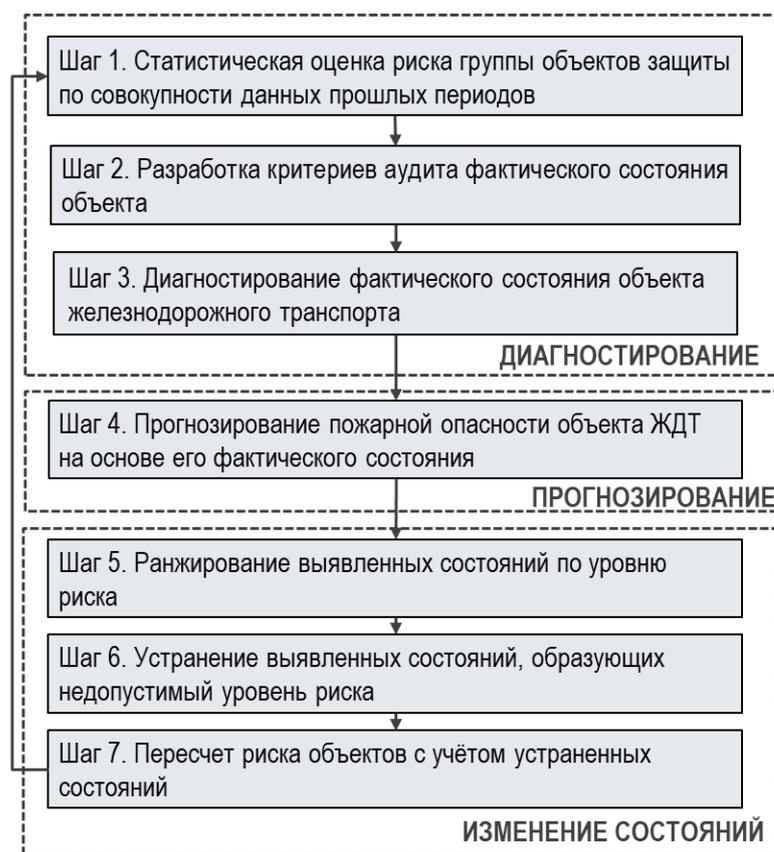
Рисунок 2.3 – Алгоритм оценки пожарных рисков на стационарных и передвижных объектах ОАО «РЖД»
