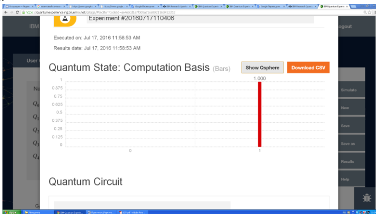
Рис. 6.4.2. Результат действия оператора X (NOT), представленный в виде вероятности состояний
