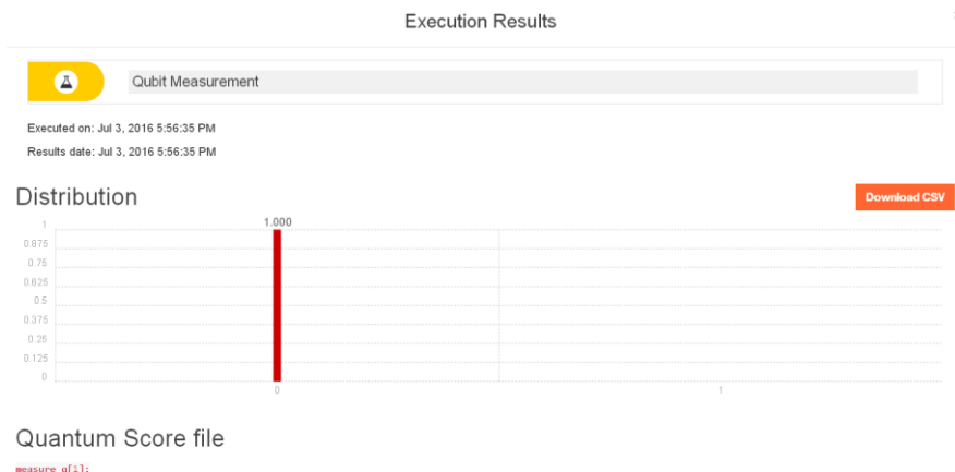
Рис. 5.2.3. Результаты квантовых вычислений: по горизонтальной оси отложены возможные значения вычисляемой величины, по вертикальной оси отложены вероятности их реализации
